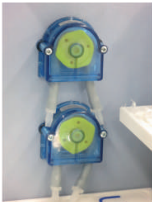
Figure 63: Easy PREP Titre EC Peristaltic Pump.
