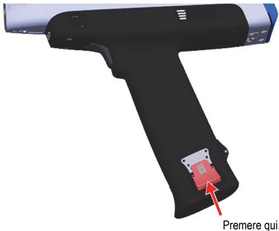
**Figura 3-10 Tasto di sblocco sinistro della batteria**
