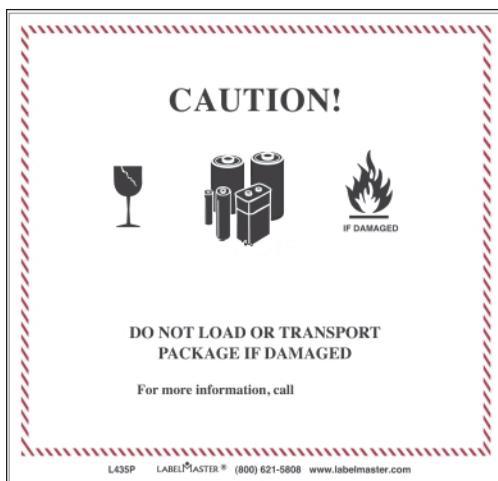
**Figura i-5 Esempio di etichetta di ATTENZIONE per le batterie agli ioni di litio**
