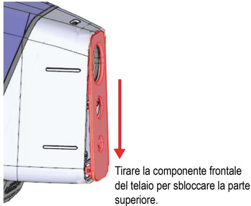
**Figura 4-3 Componente frontale del telaio sbloccata**
