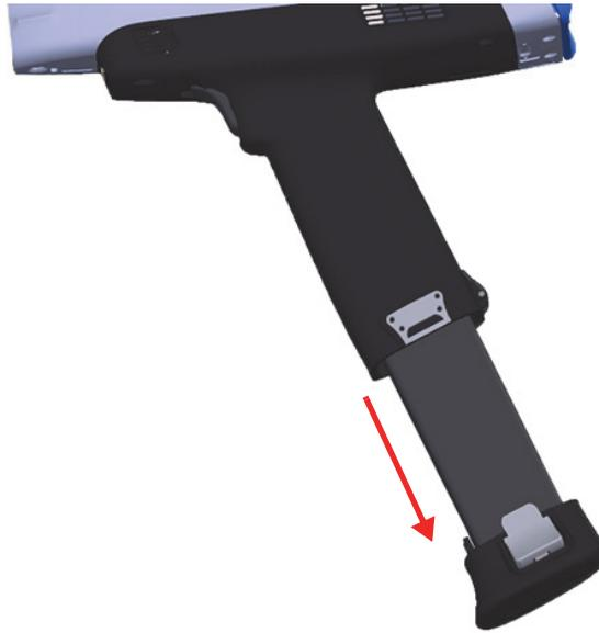
**Figura 3-11 Rimozione della batteria**
