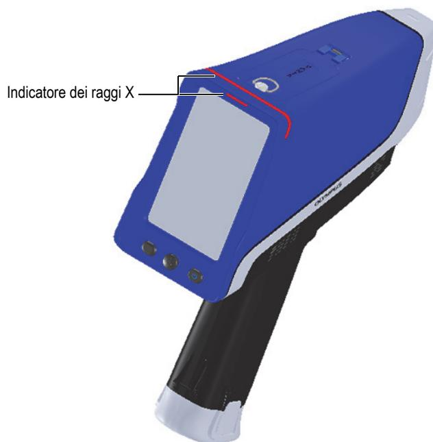
**Figura 1-2 Indicatore dei raggi X (parte superiore e posteriore)**
