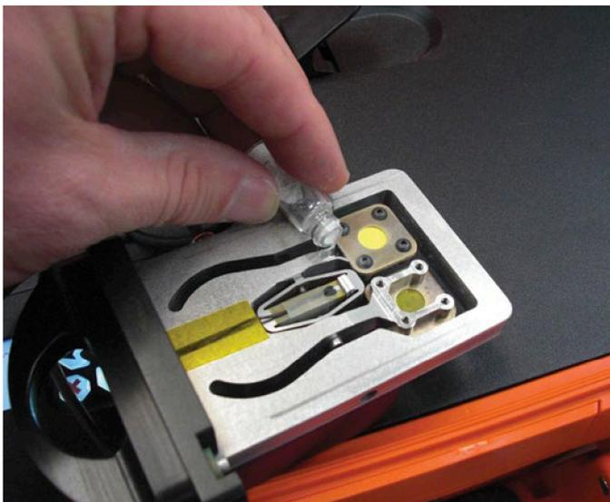
Il Terra™ semplifica le modalità di raccolta e preparazione dei campioni per le analisi con diffrazione a raggi X. In genere un campione deve essere macinato finemente e compresso fino ad ottenere un pellet, così da assicurare un'orientazione sufficientemente casuale dei cristalli.
