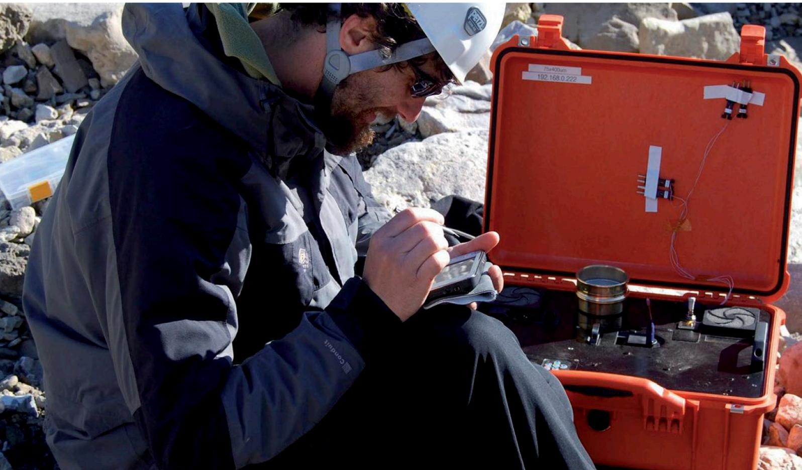
Strumento portatile e completo per l'analisi con fluorescenza a raggi X (XRF) e diffrazione a raggi X (XRD)
