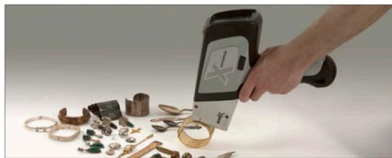
L'analizzatore DELTA può automaticamente identificare e caratterizzare un'ampia gamma di leghe inclusi i metalli preziosi come Au, Ag, Pt e Pd. Esso può essere preprogrammato per fornire una definizione immediata della caratura d'oro: 0-24 kt.
