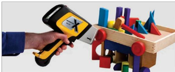
L'analizzatore DELTA può fornire risultati di tipo positivo/negativo o accettare/rifiutare per una verifica veloce a fini normativi e di sicurezza relativamente al Pb, Cd, As, Hg, Cr e ad altri metalli inquinanti presenti in prodotti di consumo. La registrazione di immagini e risultati rendono il DELTA uno strumento ideale per un programma di controllo di conformità agli standard (Reasonable Testing Program).
