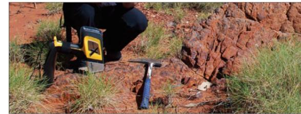
I risultati compositivi di elementi leggeri e metalli dell'analizzatore DELTA possono essere facilmente trasmessi per ottenere una mappatura geochimica istantanea mediante la sinergia tra XRF e GPS-GIS. Il DELTA permette l'immediata mappatura, visualizzazione e valutazione preliminare e successiva di siti minerari, per una migliore presa di decisione nel settore dell'esplorazione mineraria.
