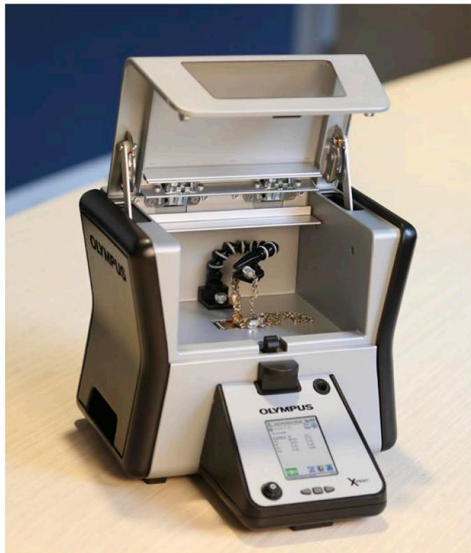
Fissare oggetti di dimensioni ridotte mediante il supporto per orientarli nella camera di analisi.
